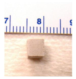
**Fig. 1**  $5 \times 5 \times 5$  mm calculus phantom.
