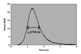
Fig. 3 QS Tm:YAG laser pulse.
