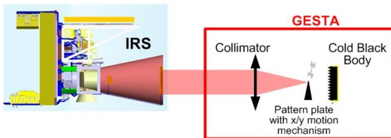
Fig. 6 Knife Edge Measurement set-up
