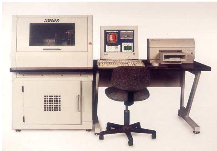
Fig. 3 : Scanning Acoustic Microscope : SONIX S.A.M. – UHR 2000
