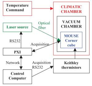
Fig. 7 : test configuration
