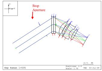
Fig. 4. Collector Subsystem
