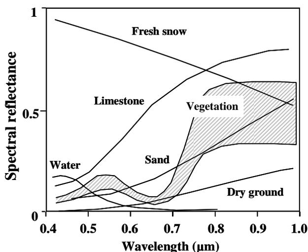
Fig.2. Ground Reflectance spectra.
